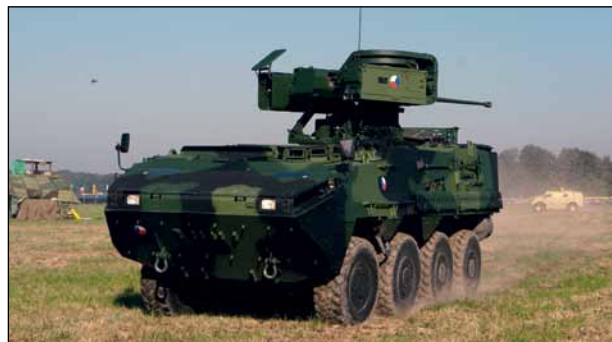
Obrněný transportér Steyr Pandur II 8x8. Jeho posádku může tvořit 12-14 osob, dosahuje maximální rychlosti 105 km/h. Může nést různé typy věží, např. Steyr SP30 s automatickým 30mm kanonem Mauser MK30-2.
