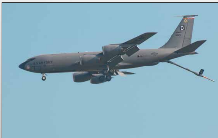
Boeing KC-135 Stratotanker je vojenský letoun určený pro doplňování paliva jiných letounů ve vzduchu. Palivo je tankováno přes tankovací rameno na zádi letounu do doplňovaného letounu. Toto rameno je obsluhováno a sledováno operátorem, který leží v ocasní části letounu.
