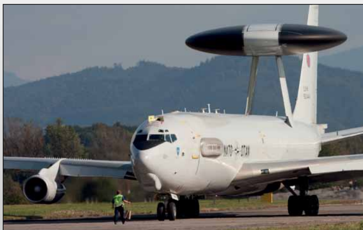
Nezaměnitelný pro svůj výrazný disk je letoun E-3A Sentry systému AWACS. Tento stroj, jehož základem je Boeing 707, je využíván pro průzkum, velení, řízení a komunikaci. Jednotka NATO E-3A Components sídlí na základně Geilenkirchen. Členy mezinárodní posádky jsou i čeští vojáci.
